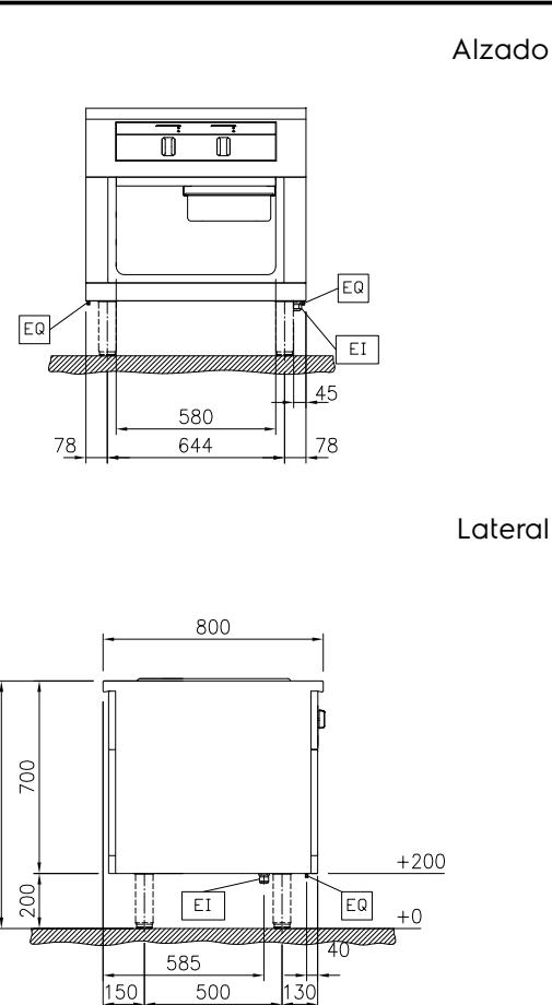
EI = Conexión eléctrica (energía)
